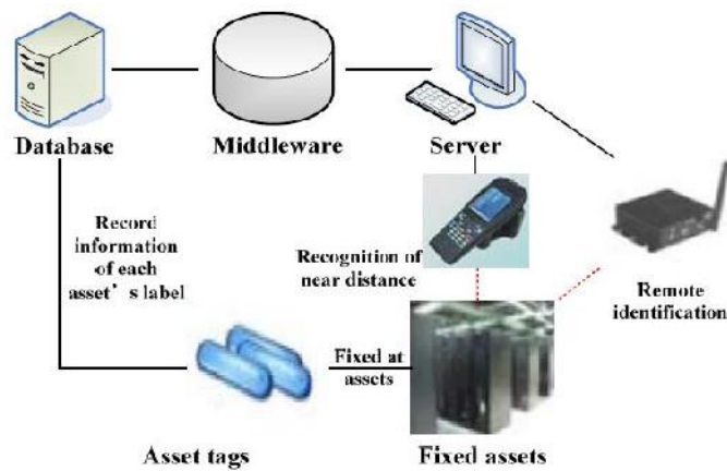
شکل ۷-۳۸: استفاده از فناوری اینترنت اشیا در مدیریت دارایی [۱۶۶]
