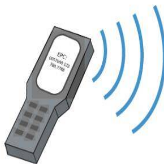
شکل ۷-۵: نمونه‌ای از یک بازخوان برچسب RFID [۱۱۷]
