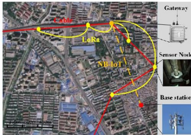
شکل ۷-۲۳: ارتباط نقطه-دروازه-سرور (ابر) در پایش تخلیه جزئی کابل در شهر جینان ۲ چین
